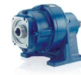
Los reductores Cyclo® de bajo juego interno para motores Servo 6000 están basados en el concepto cicloidal. Ofrecen una combinación excelente de alta capacidad de carga, baja inercia, bajo nivel de ruido y altas relaciones de reducción.
